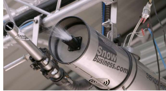
Итерации на сложния дизайн на дюзата (ляво) и крайната 3D отпечатана част в действие (дясно)
