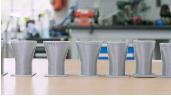
Итерации на сложния дизайн на дюзата (ляво) и крайната 3D отпечатана част в действие (дясно)
